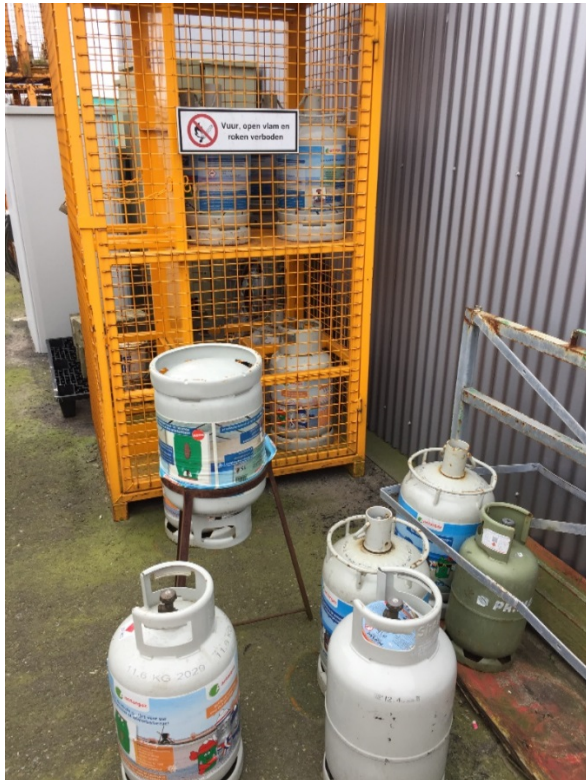
Gasflessen niet in het daarvoor bestemde gasflessenrek geplaatst
