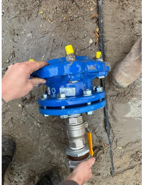
Abbildung 3 - Herausgeschleudertes Klemmflansch
