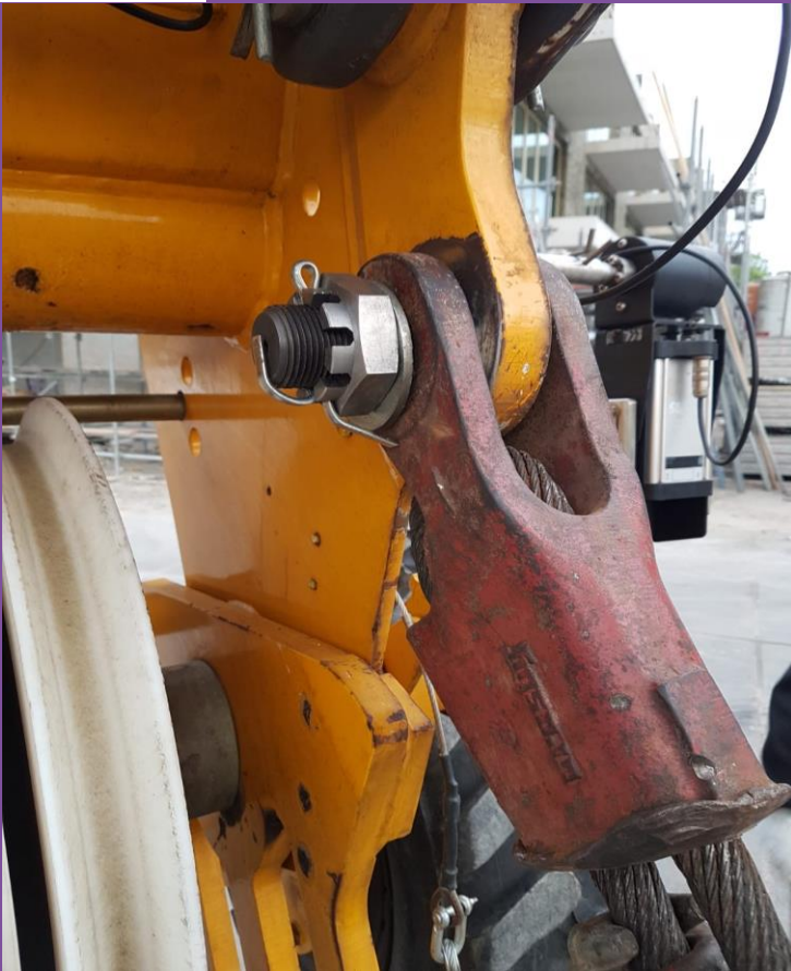
Foto 4: Dubbele borging door kroonmoer met omgezette splitpen
